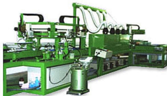
ガラス板切断後の端面加工及び、シリコン塗布
