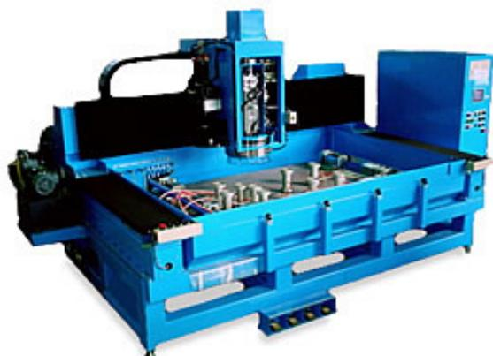
あらかじめ切断されたガラスの糸面、コバ面の面取りをサーボ3軸で行う装置
