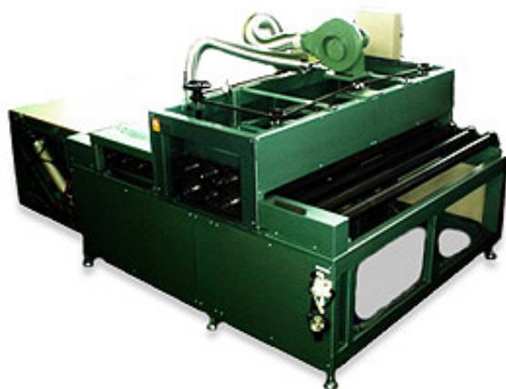
2枚のガラス間の樹脂を熱し、圧着させる装置
