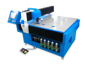
2軸サーボを用い、任意寸法にガラスを切断する装置(簡易NC切断機)
