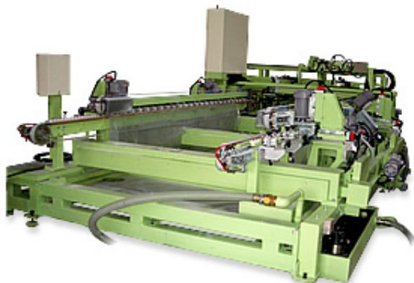
ガラス板の上下糸面取り、端面荒加工及び磨き加工、4コーナー角面取り加工をする装置
