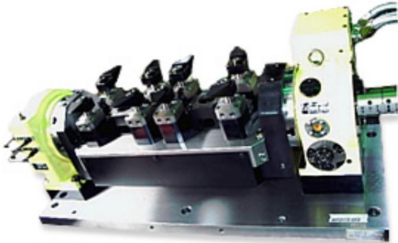
鋳物部品の加工機（マシニングセンタ）に載せ、ワークをクランプ、反転させる治具
