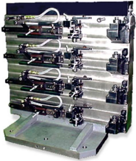
加工機（マシニングセンタ）に取付け一度に8個（片面4個）のワークをクランプ
