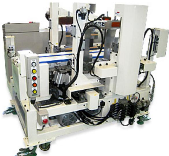
搬入した発泡スチロールの箱を1～6段の任意の数に段積みして払い出す装置
