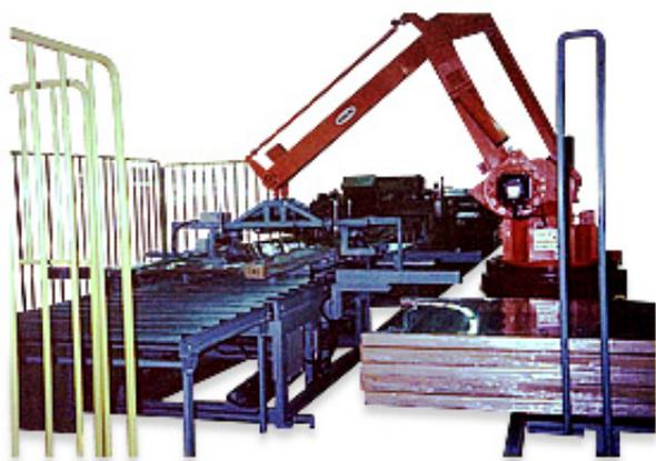
包装されたフェンスをロボットにより搬送し、パレットに積込む
