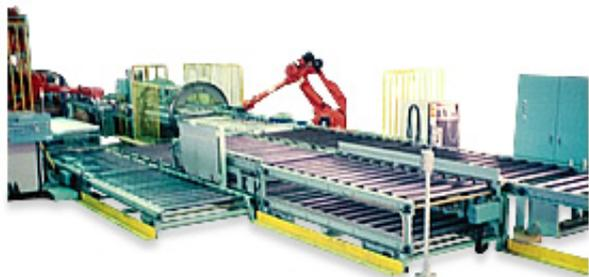
石膏ボードに鋼板をホットメルトで貼付けし、搬出パレットに積上げる
