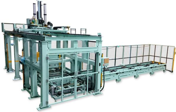
加工ラインから搬出されてきたワークをパレット上所定の位置・向きに積み込む装置
