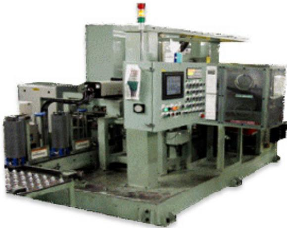
薄い円環状ワークの厚さを複数点測定し、特定位置にレーザー（YAG）刻印する装置
