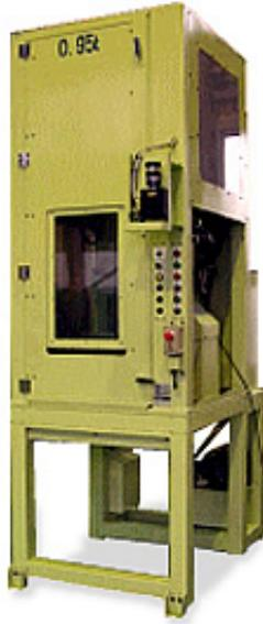
円筒状アルミダイキャスト品の湯道切断を高能率で行う特殊用途の切断専用機
