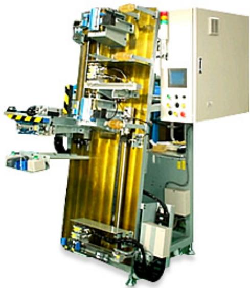
戸先框に定寸の引寄せピース穴あけ、ポンチング加工を行う装置
