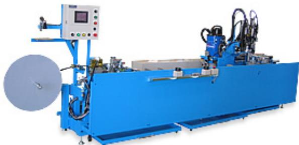
アルミ型材にタイト材挿入及びクレセントを指定寸法に正確に取付ける装置
