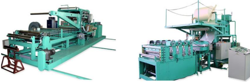
屋根材用鋼板に断熱材をホットメルトにて貼付けし、所定の長さで切断する装置
