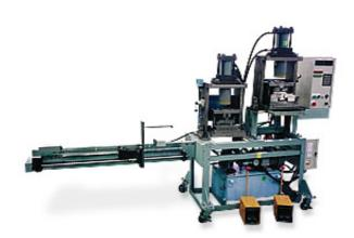
形材の中間部に金型により穴あけ、切欠き加工をする装置
