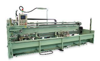
下枠にレール材をはめ込んだワークを、穴明けビス締めを共加工する
