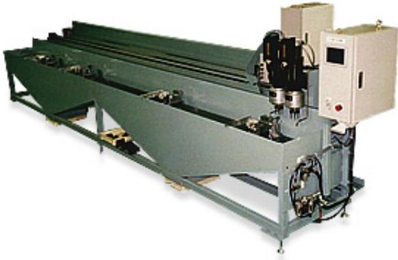
フェンス用手すりに多軸ヘッドで穴明け・タップ加工をする
