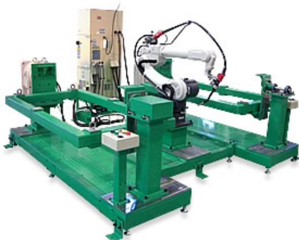
両側ポジショナーにて角度決めし、中央のロボットにて自動で溶接を行う装置
