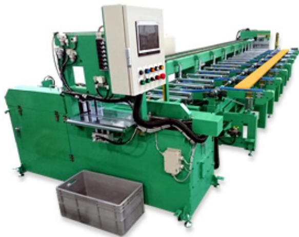
素材アルミ型材を所定の長さに自動で連続切断する装置
