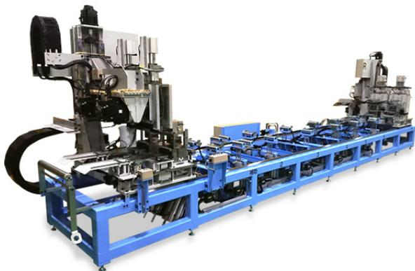
レール状の押出素材(アルミ・ステンレス・スチール)に自動でパンチ穴を開け、所定長さに切断する装置
