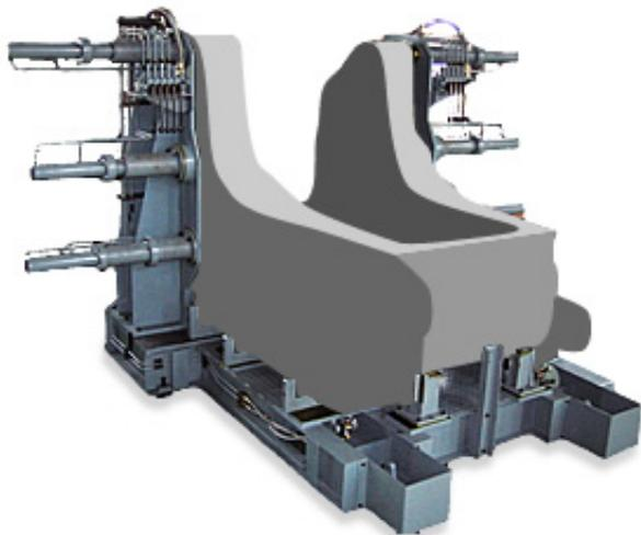
仮付けワークを位置決めピンで正確にセット後、ハンドバルブにてクランプする
