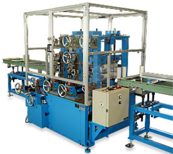
ナーリング(ミゾ加工)済みのアルミ形材と断熱材をカシメて一体化する装置
