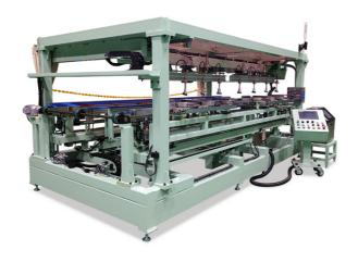
パーテーションパネルの製品寸法(外枠折込寸法)を確認する装置です
