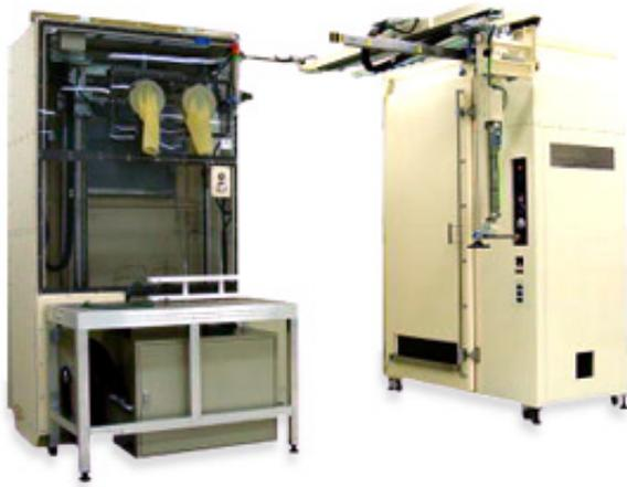
極低湿度下で細いワイヤー状ワークに2液性樹脂をコーティングする装置
